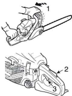
1. Тормоз цепи переведен в положение ВЫКЛЮЧЕН.
