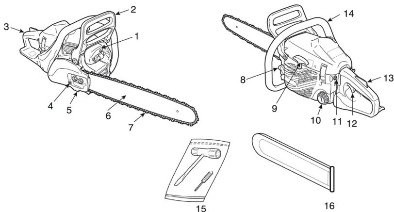
1. Глушитель — служит для снижения шума выпуска отработавших газов и гашения искр.
