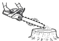
Держите цепь над сухой поверхностью и откройте дроссельную заслонку, установив частоту вращения коленчатого вала на половину от максимальной, и удерживайте в таком положении 30 секунд. Тонкая линия «выброшенного» масла должна появиться на сухой поверхности.
