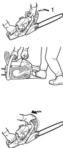
1. Тормоз цепи переведен в положение **ВКЛЮЧЕН**. Убедитесь, что в топливном баке имеется топливо, а резервуар для масла наполнен смазкой. Толкните передний защитный щиток вперед. (Тормоз цепи переведен в положение **ВКЛЮЧЕН**).
